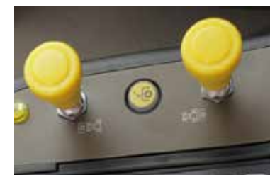
Activation électro-hydraulique de la prise de force avant et arrière.
