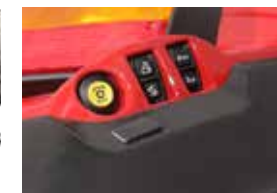
Les commandes extérieures du relevage hydraulique, de la prise de force et d'un distributeur supplémentaire sont situées à l'avant et à l'arrière du tracteur.
