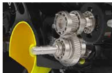
Transfert direct de la puissance du moteur à la prise de force avant.
