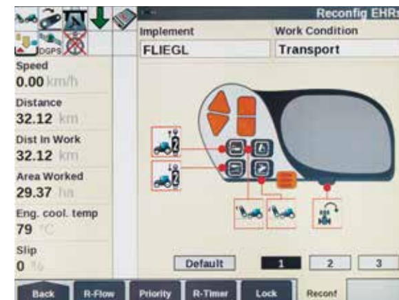
Grâce à la fonction ISOBUS AUX N vous pouvez configurer des commandes de l'accoudoir pour commander directement l'outil.
