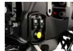
Les commandes extérieures du relevage hydraulique, de la prise de force et d'un distributeur supplémentaire sont situées à l'avant et à l'arrière du tracteur.
